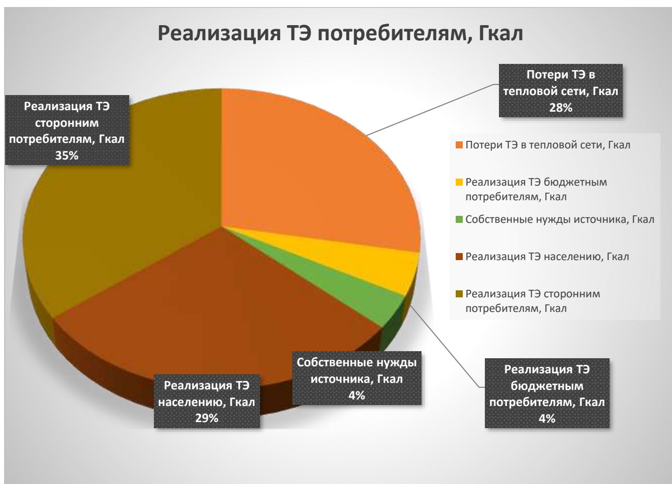
Рисунок 3. Потребление тепла котельной пгт. Рудничный
